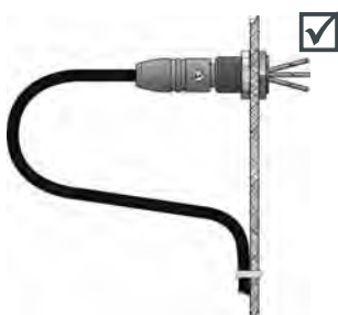
Entlastungsschleife – richtig Correct stress loop
